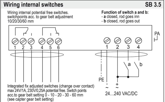
**Wiring diagram InRun-...-P**
