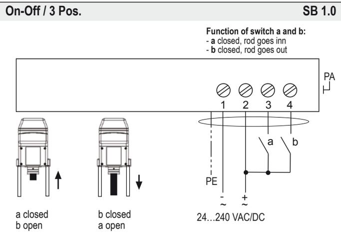
**Wiring diagram InRun-...-S**
